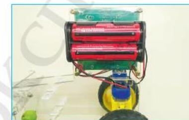
Рис. 16.10. Сборка робота. Шаг 7. Аккумуляторы
