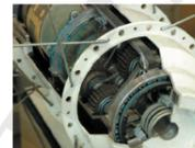
Рис. 5.30. Мотор-колесо, двигатель *Лунохода*, видно форму крышки и массивы отверстий (по материалам enlight.ru, П. Соболев, ВНИИТМ)
